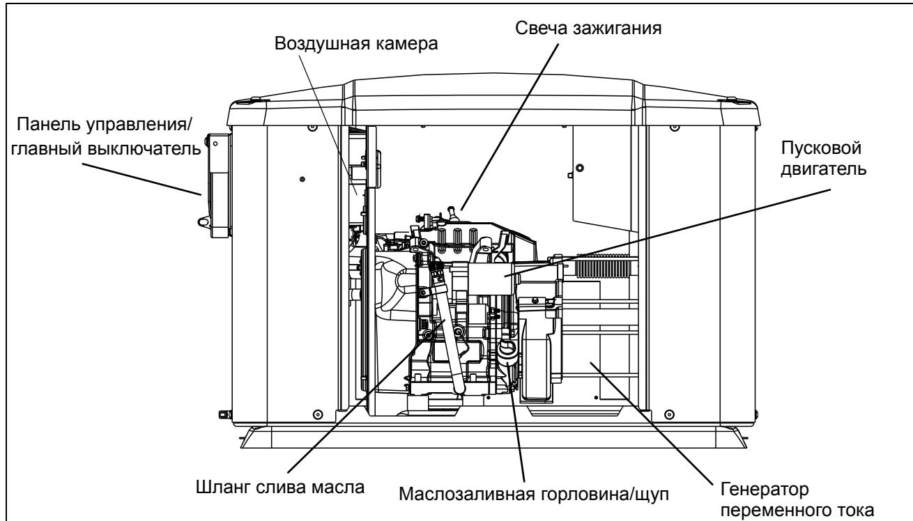
**Рис. 2-1. Двигатель GA-420 генератора мощностью 5,6 кВ·А**
