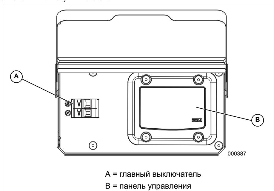
**Рис. 3-3. Расположение панели управления и главного выключателя**
