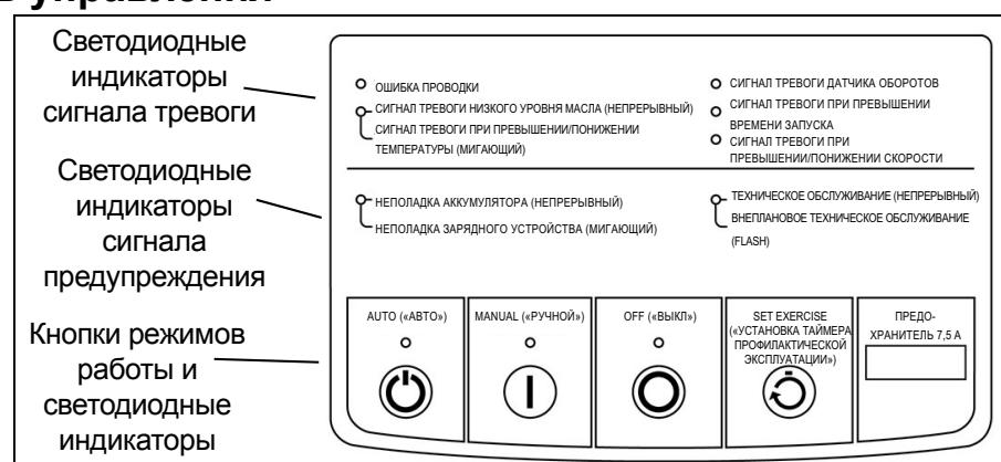
**Рис. 3-4. Панель управления генератора и светодиодные индикаторы**
