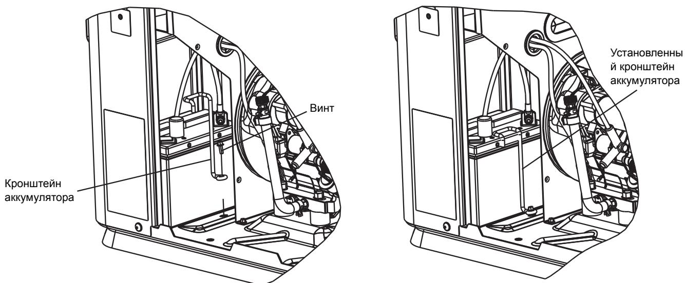
**Рис. 4-7. Установка аккумулятора**
